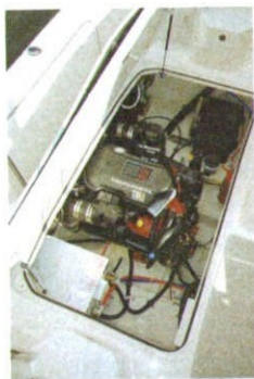
Konehuoneessa on hyvin tilaa huoltotoimille ja lisävarusteille, kuten etuvasenmalla näkyvälle lämmönsäätölle.
