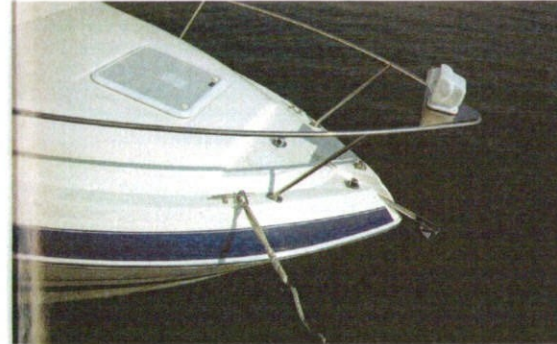
Umpinainen ja keulaa ulommas työntyvä kaide pitää huolen siitä, että keulan kautta veneeseen kulku on erittäin haasteellista. Knaapeja on lukumääräisesti runsaasti (7 kpl), mutta ne ovat perinteiseen jenkittyyn pienikokoisia.
